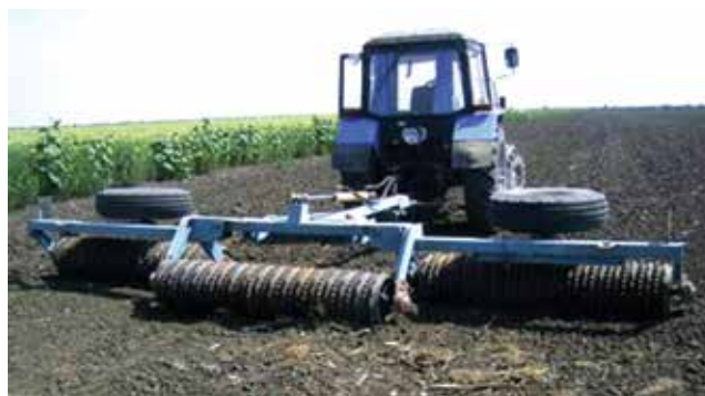
Рис. 6. Коток КЗК-6П (в робочому положенні)
