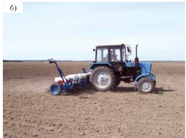
Рис. 1. Сівба насіння цукрових буряків сівалками Amity (а) та УПС-12 (б)
