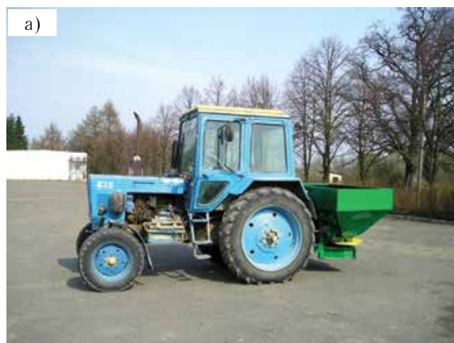
Рис. 2. Машини для внесення мінеральних добрив: а – МВД-900; б – МХ-850L
