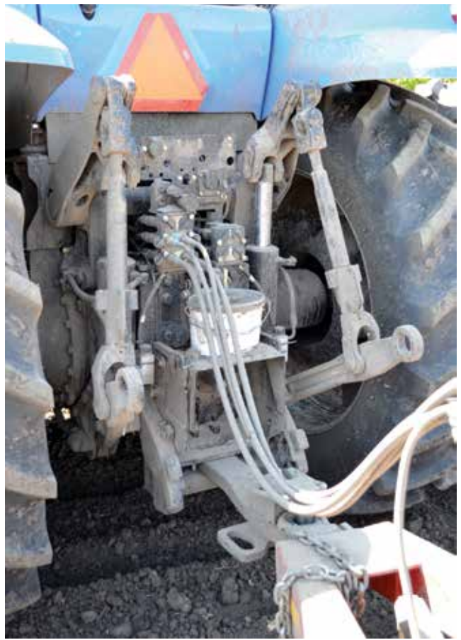
Нова гідросистема із п'ятьма гідровиходами та продуктивністю гідронасоса 274 л/хв
