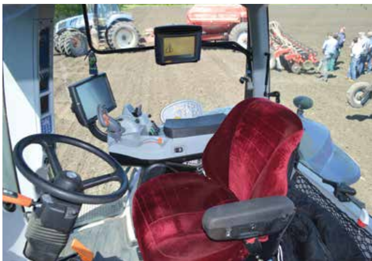
Нова кабіна отримала найнижчий рівень шуму – 68 дБ, велику площу засклення – 6,3 м² та інформативний підлокітник SideWinder™ II
