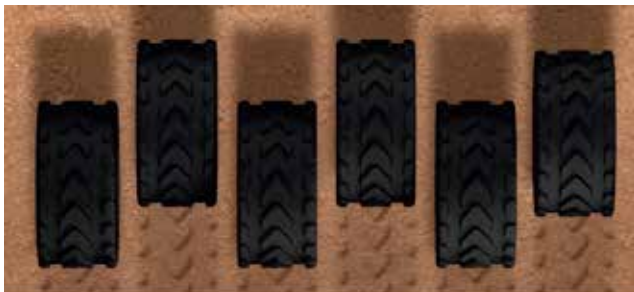
Шахове розміщення коліс знижує потребу в тягових зусиллях трактора та забезпечує рівне переміщення машини
