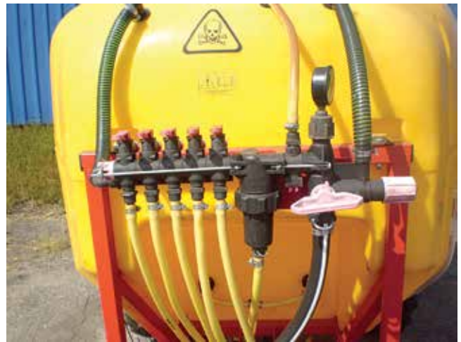
Регулятор тиску з розподільником служить для встановлення необхідного тиску в напірній комунікації і подачі рідини на кожен секцію розподільника
