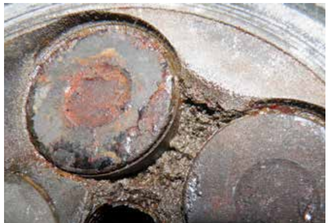
Плавлення стінки камери згоряння між сідлами випускних клапанів — це одна ознака сильного перегріву
