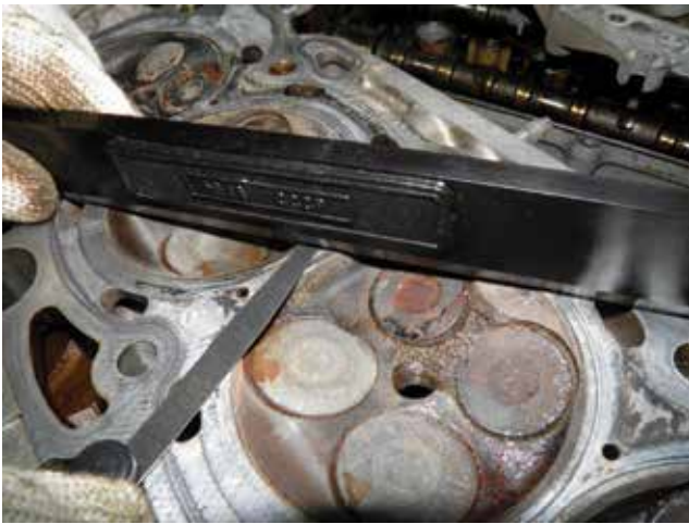
Типова ознака перегріву двигуна в його початковій стадії — деформація площини головки блока циліндрів
