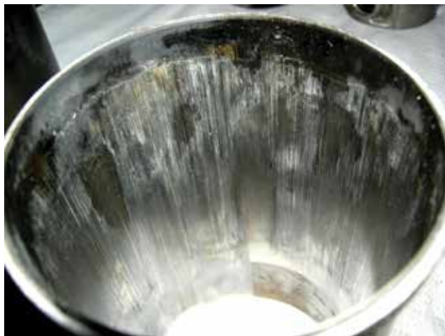
Задири на дзеркалі циліндра від перегрітого поршня
