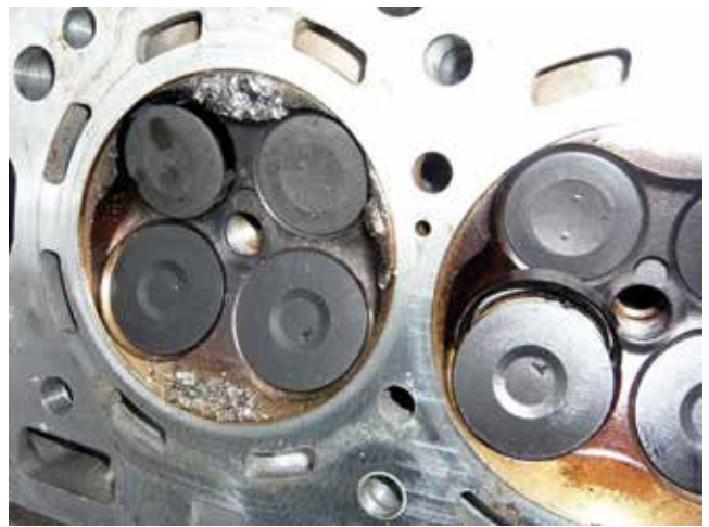
Типовий причинно-наслідковий зв'язок: сильний перегрів — випадання сідел клапанів — пошкодження головки блока циліндрів
