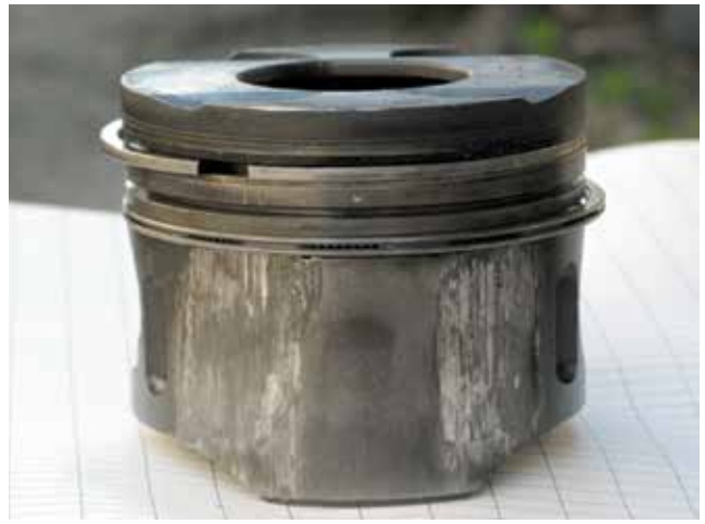
Відсутність достатнього охолодження циліндра викликає розширення поршня уздовж пальця — при цьому збільшується тертя і з'являються задири на краях юбки
